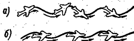
Рис. 159. Полет в зоне атмосферных волн с малой скоростью (а) и с большой скоростью (б).
